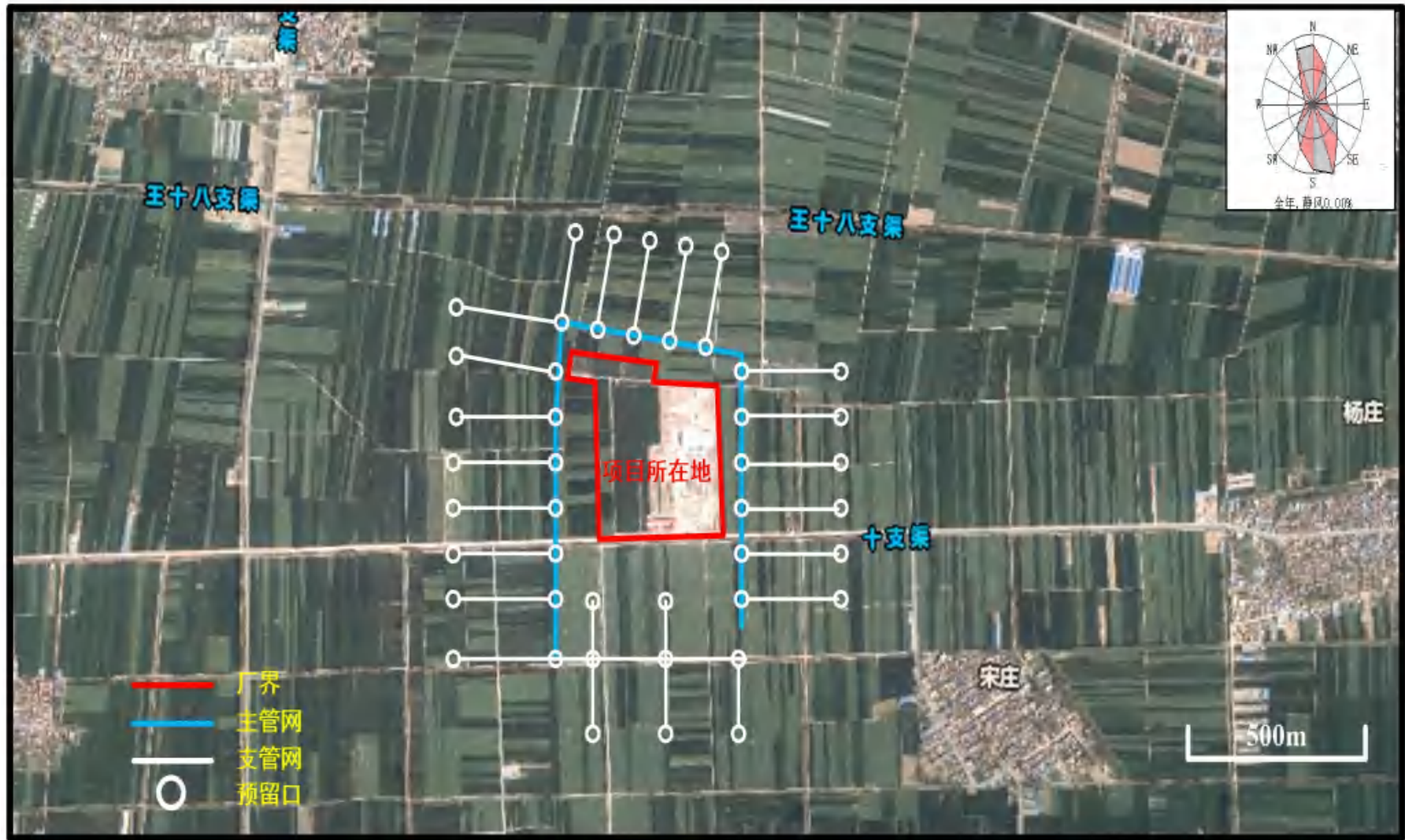
附图 4：沼液消纳区管网分布图
