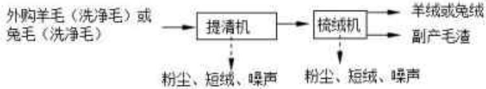
图 2 项目生产工艺流程图
